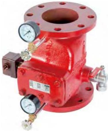
자동경보밸브는 습식 스프링클러시스템 설치용 유수검지장치로서 아파트 또는 오피스텔 등에 주로 많이 사용됩니다. 1,2차 배관에 모두 가압수가 충입되며 스프링클러헤드 1개 이상이 개방되면 가압수가 방출되며 화재경보를 발신하게 됩니다. 배관 내 수격으로 인한 압력변화에 오보가 없도록 알람 스위치에 지연타이머를 장착하였습니다.
